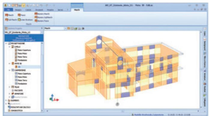
scale, coperture, catene, etc.) si ricava l'input completo del modello di calcolo con definizione dei materiali, analisi dei carichi, verifiche di legge, etc.
